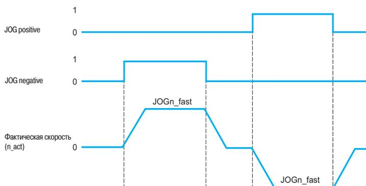
Управление движением механизма в ручном режиме при непрерывном перемещении (speed JOG)
