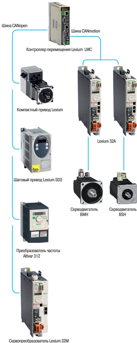
Пример архитектуры системы управления с применением шин CANopen и CANmotion
